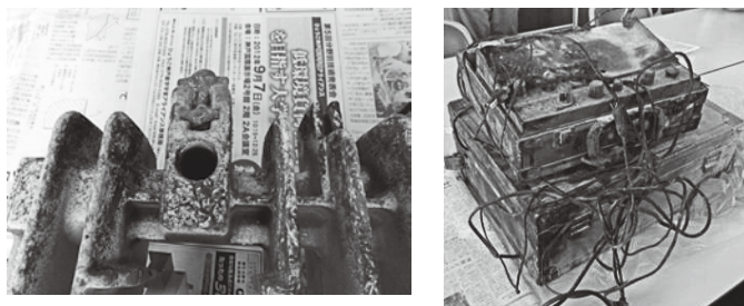
写真3. アークにより溶損した遮断器1次側の端子と絶縁抵抗測定器
