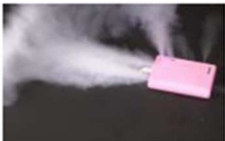
白煙発生（可燃性ガスも発生）
